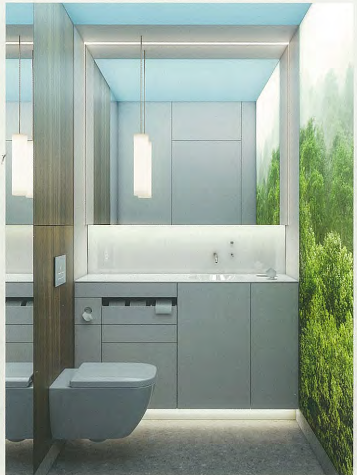
Frische temperierte Luft, die für ein gesundes Raumklima in innenliegenden WCs unerlässlich ist, wird über den Sockelbereich zugeführt und über die umlaufende Schattenfuge an der Decke abgesaugt.
